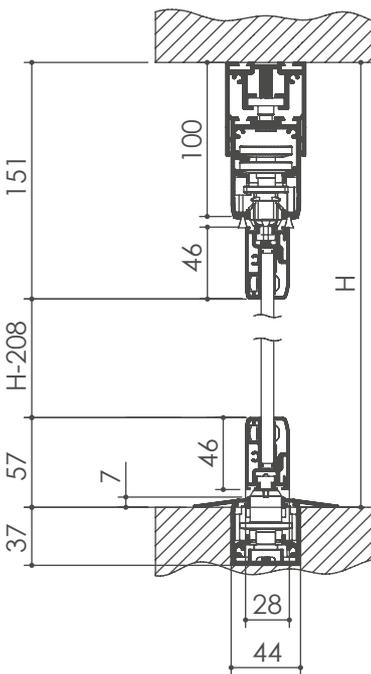
**Superiore:** guida superiore e profilo di compensazione
