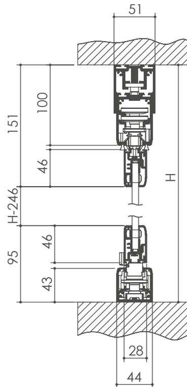
**Superiore:** guida superiore e profilo di compensazione
